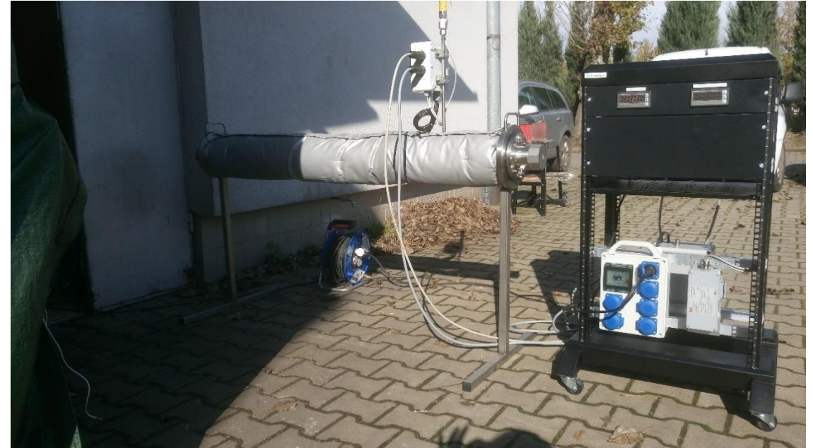
Analizator LaserGas® Single Path II do pomiaru \text{NH}_3+\text{H}_2\text{O} w spalinach – wersja przenośna
