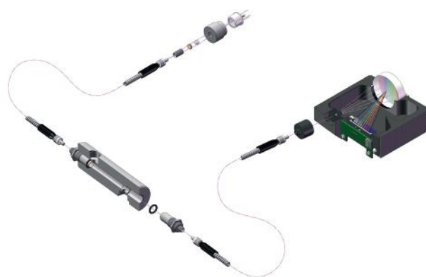
Schemat budowy analizatora dyspersyjnego firmy AAI ze zewnętrzną kuwetą pomiarową
