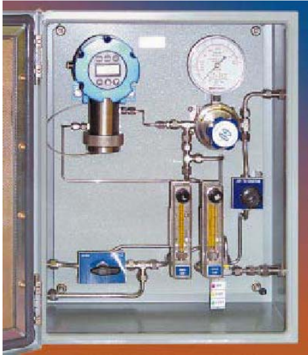
Przetwornik Insta Trans do pomiaru śladowych ilości O 2 w przemyśle petrochemicznym
