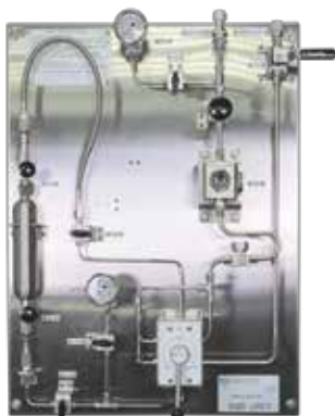
Panel poboru próbki węglowodorów
